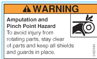
Joonis 3 KLEEBIS, HOIATUS, KÄSI RIHMA VAHEL, AINULT MOOTORIL P/N 5103184 Amputeerimise ja pitsituse oht Pöörlevate osade põhjustatud vigastuste vältimiseks hoidke nendest osadest eemale ning hoidke kõik kaitsekiibid ja kaitsepiirded paigal.
